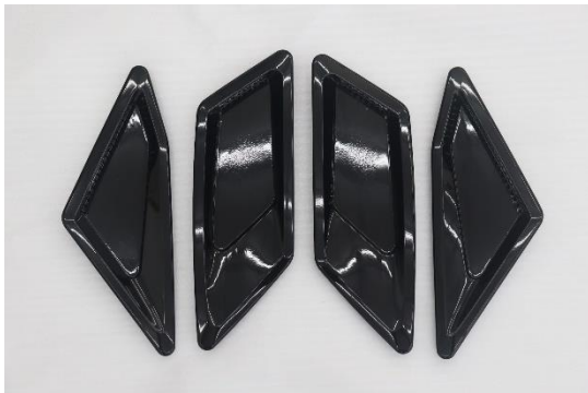
エアダクトベゼル部（ダイレクトペレット式 3D プリンティング部品）
