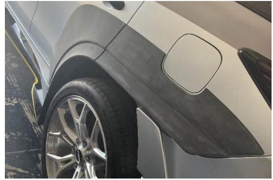
リアオーバーフェンダー部品 (ダイレクトペレット式 3D プリンティング部品、塗装前)
