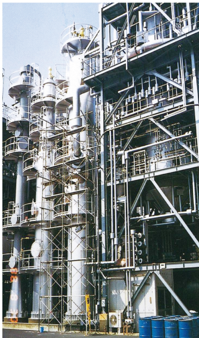
ウレタン原料の製造時に発生する副生塩化水素から塩素を効率的に回収するMT-クロルプラント (自社開発した世界初の塩酸酸化法による塩素回収設備) / 1988 (昭和63) 年
