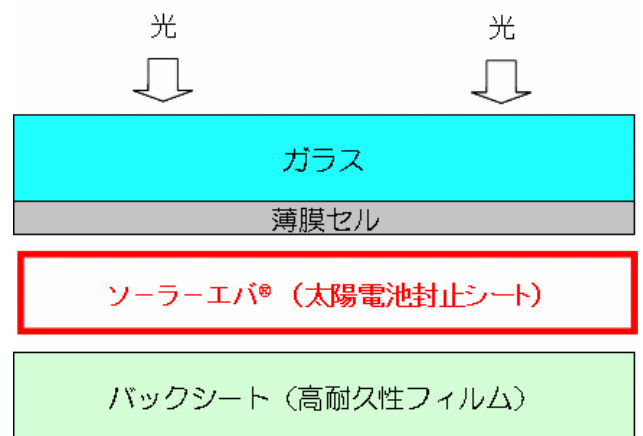
薄膜型太陽電池の構造(一例)
