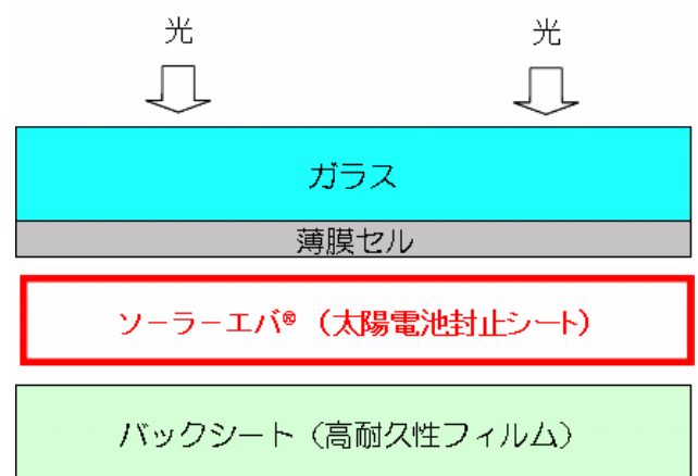
薄膜型太陽電池の構造(一例)
