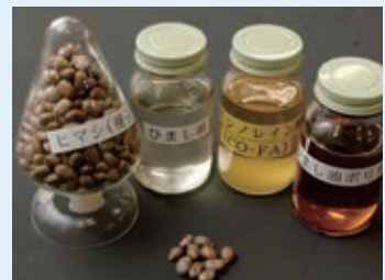
左端が原材料のひまし（種子）。順に、ひまし油、リシノレイン酸へと加工・精製し、右端のひまし油ポリボールができる。
