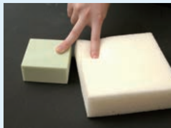
硬度の異なる2つのひまし油由来ポリウレタンフォーム（左が硬質フォーム、右が軟質フォーム）
