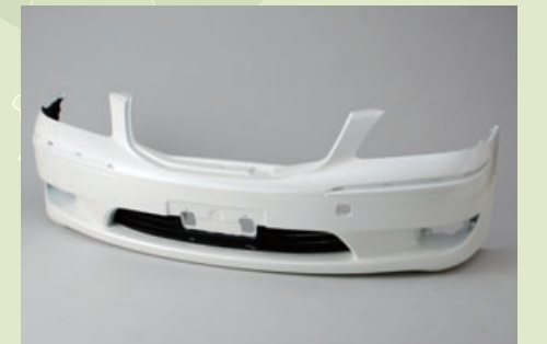
ポリプロピレン (PP) コンパウンドを使用した自動車用バンパー
