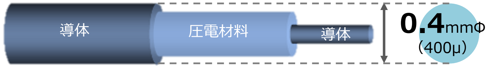
(拡大図) 同軸線構造の圧電センサ
