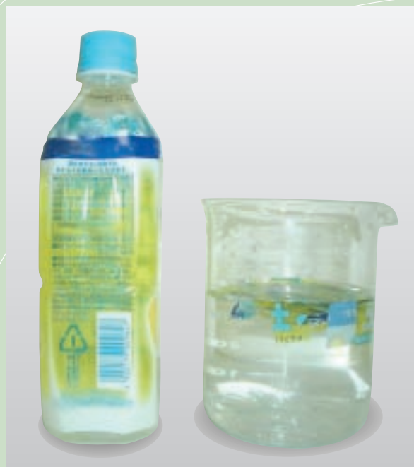
写真1 ポリオレフィン樹脂を使ったラベル（上） 水に沈むペット樹脂と水に浮くポリオレフィン樹脂（右上）
