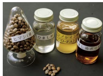
1番左が原材料のひまし(種子)。右隣のひまし油、リシリン酸へと加工・精製し、1番右のひまし油ポリオールができる。
