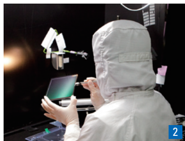
1 最先端のフォトマスクは1セット数億円もする製品もある。 2 ペリクルはクリーンルームの中で製造、チェックを受ける。
