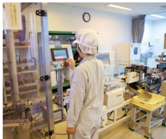
「スーパーボンド®・モノマー液」の充填作業の様子
