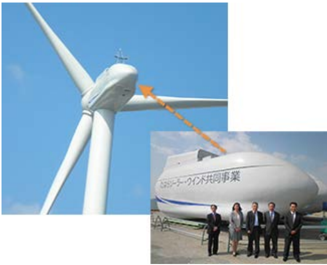
ダウンウィンド型ブレード（左）と タワー上部に設置するナセル（右） <2014年4月 撮影>
