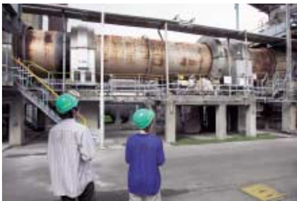
廃棄物の一部は、ダイオキシンが発生しないように焼却している。
