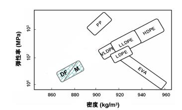
タフマー™ DF & Mは、伸び、柔軟性、低温耐衝撃性、耐傷付き性を改良します。 架橋することで、耐熱性が向上します。
