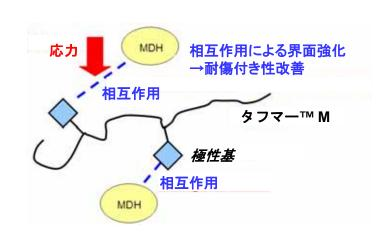
タフマー™ MはMDHとエチレン系材料の界面を強化し、耐傷付き性・折り曲げ時の耐白化性を改良します。
