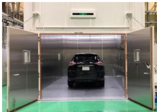
設備の一部である「恒温恒湿槽」 （車両状態での評価が可能）
