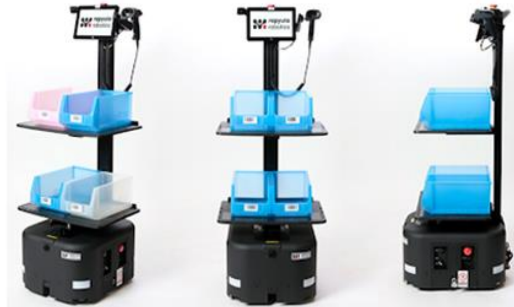
ラピュタロボティクス社 ラピュタPA-AMR(ピッキングロボット)
